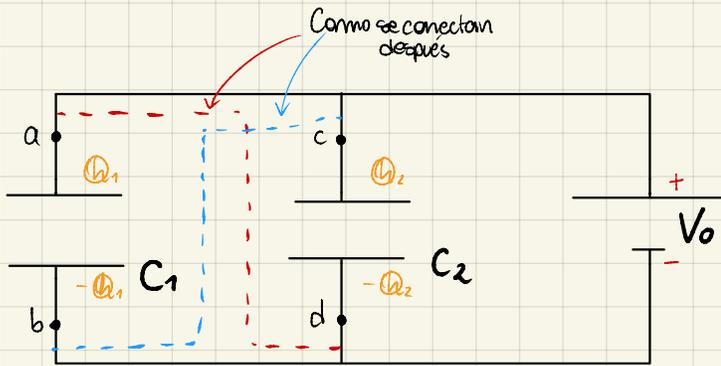
El potencial en todo el circuito es  $V_0$ , por lo que la carga de una de las caras de cada condensador está dada por
