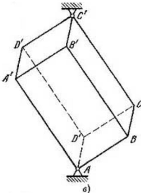
**Hint:** considere que el sólido solo gira en la dirección de  $\hat{k}_I$  (la vertical de toda la vida y que está contenida en la recta  $\overline{AC'}$ ), por lo que no tiene movimiento de rotación ni nutación, **solo tiene precesión** (en ángulos de Euler:  $\dot{\theta} = \dot{\psi} = 0$ )
