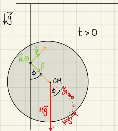
y el torque producido por la gravedad sería  $\vec{\tau} = \frac{R}{2} \hat{p} \times (-Mg \hat{y}) = \frac{R}{2} \hat{p} \times (Mg \cos \phi \hat{p} - Mg \sin \phi \hat{\phi}) = -\frac{MgR}{2} \sin \phi \hat{k}$
