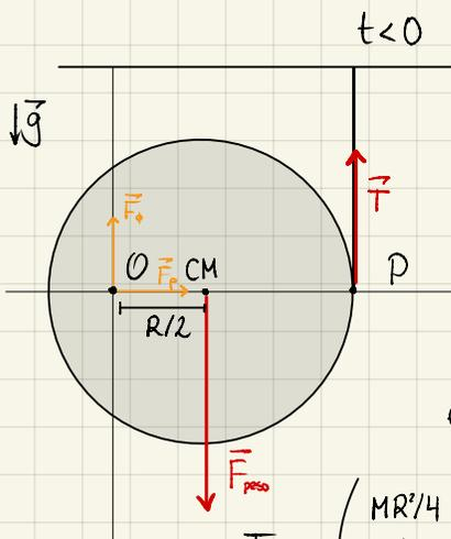
a) En la P1 ya calculamos el tensor de inercia para un disco delgado de radio  $R$  y masa  $M$  distribuida homogéneamente. Además encontramos la expresión general para hacerle Steiner al  $I_{cm}$  de este objeto, en este caso la traslación de origen es
